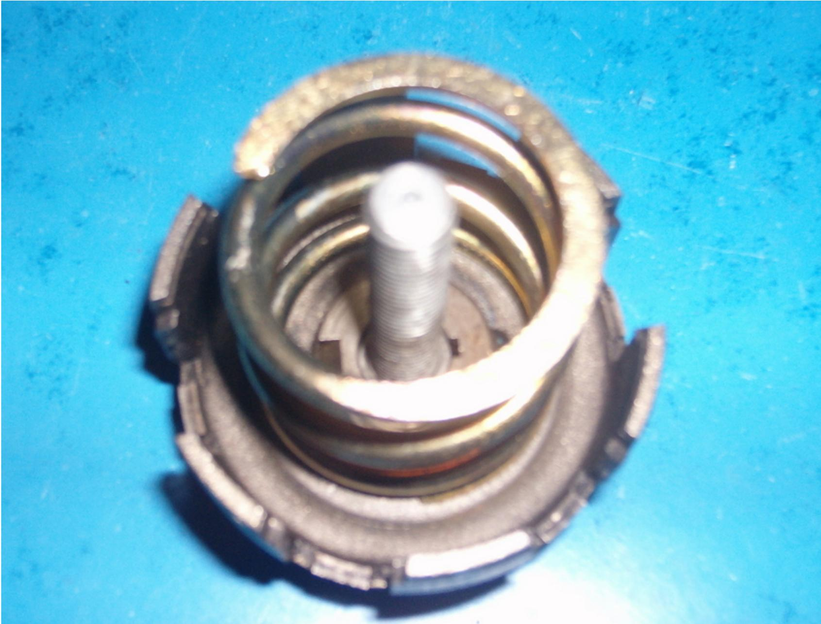
En la foto siguiente se puede apreciar la diferencia entre el original y el Malossi, ojo este último endurece muchísimo el embrague, solo lo recomiendo en una vespa con preparación, para circular normal termina siendo incómodo:
