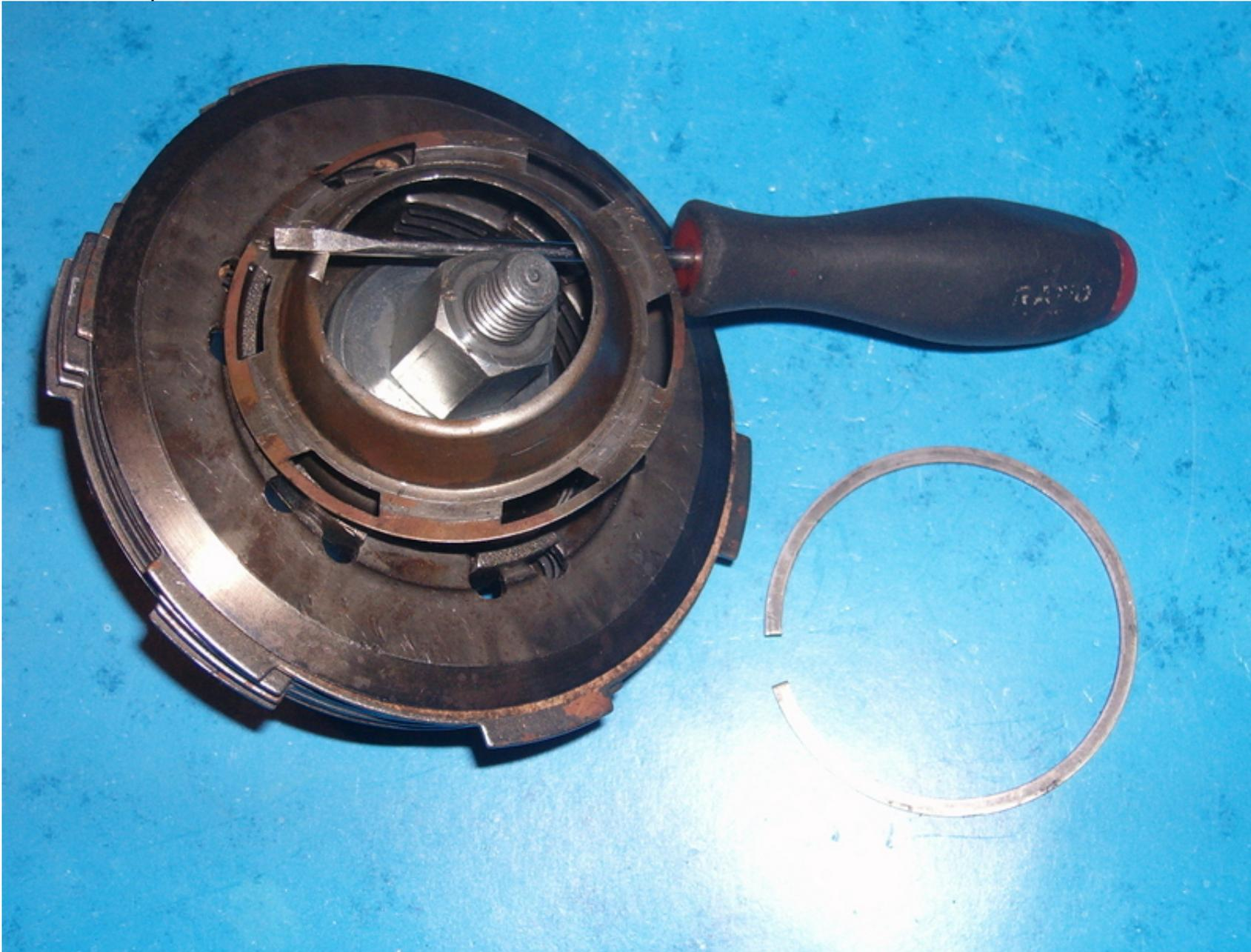
Y el Clip, ojo eso tiene que soportar la presión, así que aseguramos montarlo bien encajado en sus ranuras:
